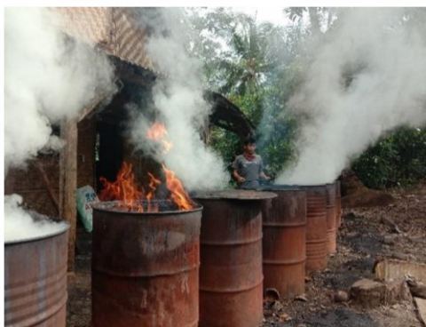
Gambar 4 Proses Pembakaran Arang dari Kelapa (Sumber: Peneliti, 2022)
